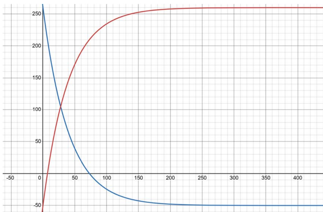
Рис. 1. Переходной процесс термометра сопротивления. Составлено авторами Fig. 1. Transient process of a resistance thermometer. Compiled by the authors
