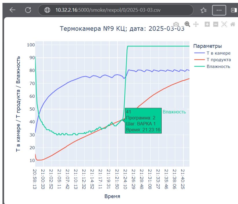
Рис. 3. Веб-страница с информацией о работе термокамеры. Составлено авторами Fig. 3. Web page with information about the operation of the thermal chamber. Compiled by the authors
