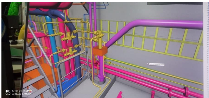
Рис. 3. Трёхмерная модель судовых систем трубопроводов. Составлено авторами Fig. 3. Three-dimensional model of ship pipeline systems. Compiled by the authors
