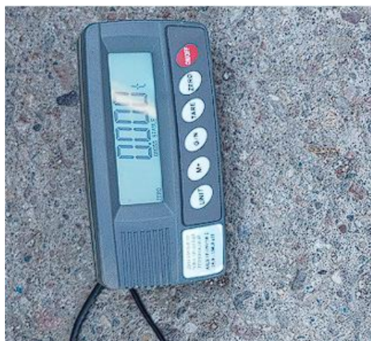
Рис. 3. Электронный динамометр с максимальным тяговым усилием 50 kN. Фото сделано авторами Fig. 3. An electronic dynamometer with a maximum pulling force of 50 kN. The photo was taken by the authors
