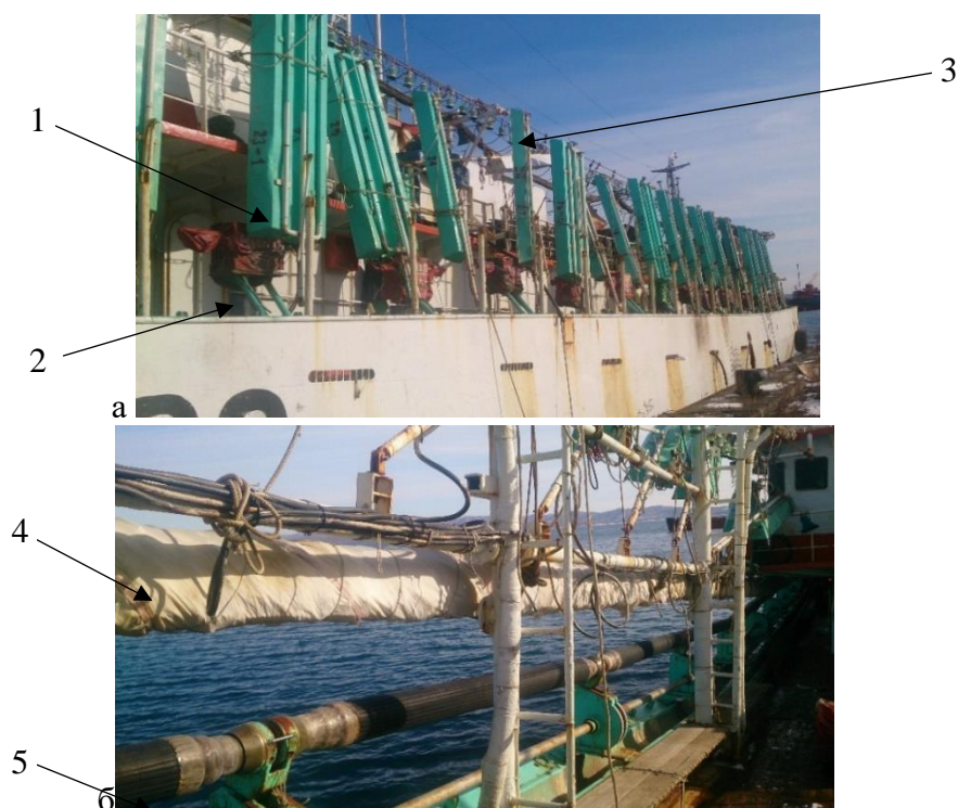
Рис. 1. Тайваньское специализированное судно для промысла сайры и кальмара в океане: а – кормовая часть левого борта; б – правый борт: 1 – световая люстра для промысла сайры; 2 – кальмароловная лебёдка (в чехле); 3 – световая гирлянда для промысла кальмара; 4 – сайровая сигара, закреплённая попоходному; 5 – машины для подсушки сетной части ловушки во время выборки. Составлено авторами Fig. 1. Is a Taiwanese specialized vessel for saury and squid fishing in the ocean: a – the aft part of the port side; б – the starboard side: 1 – a light chandelier for saury fishing; 2 – a squid fishing winch (in a case); 3 – a light garland for squid fishing; 4 – a saury cigar, fixed in a camping manner; 5 – machines for drying the net part of the trap during sampling. Compiled by the authors
