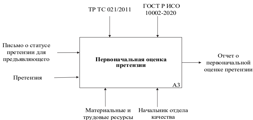
Рис. 3. Функциональный блок А3 «Первоначальная оценка претензии» Fig. 3. Functional block A3 «Initial assessment of the claim»
