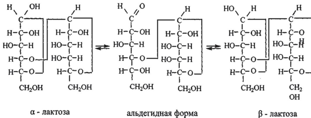
Рис. 4. Фрагмент лактозы двух оптических изомеров \alpha - и \beta -формы
