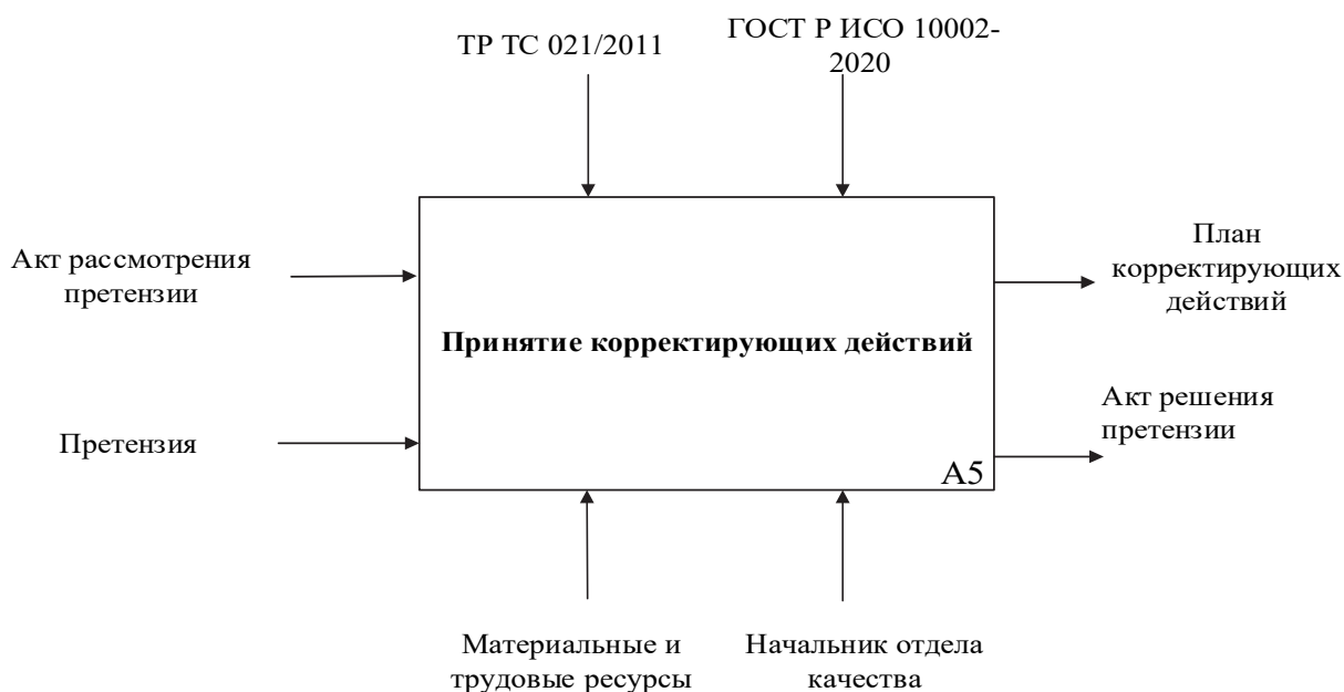
Рис. 5. Функциональный блок А5 «Принятие корректирующих действий» Fig. 5. Functional block A5 «Taking corrective actions»
