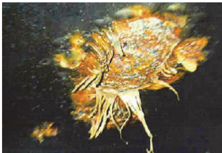
Рис. 3. Коррозия в зоне вмятины от удара Fig. 3. The impact dent area corrosion
