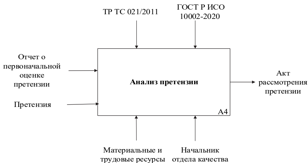
Рис. 4. Функциональный блок А4 «Анализ претензии» Fig. 4. Functional block A4 «Claim analysis»
