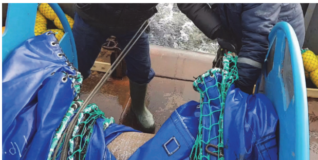
Рис. 16. Наматывание ГРУ на кабельно-сетной барабан Fig. 16. Winding the GRU on a cable-net drum
