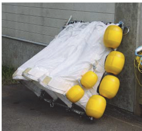
Рис. 12. Гибкий распорный щиток [9] Fig. 12. Flexible spacer shield [9]
