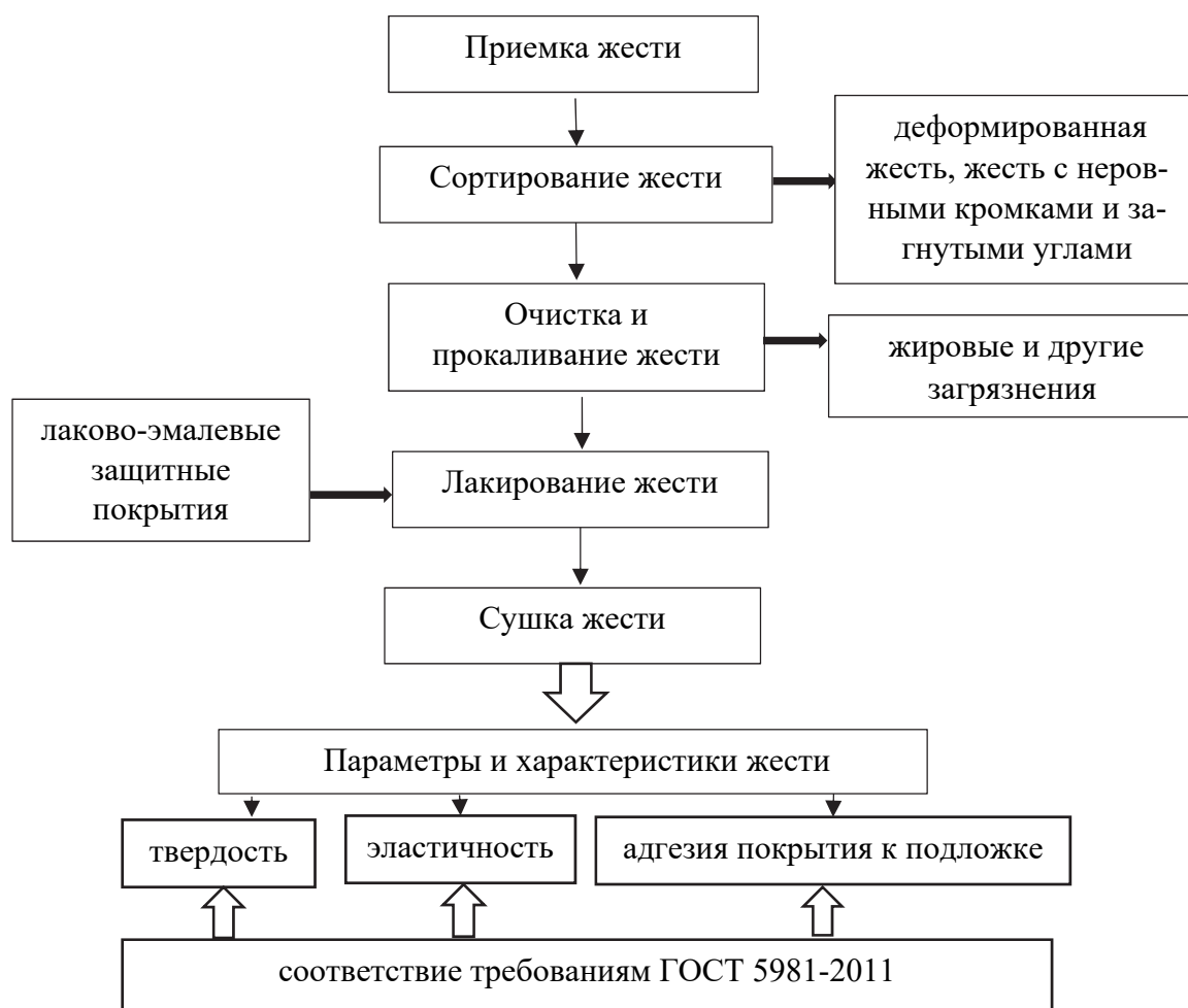
Рис. 1. Технологическая схема нанесения защитных покрытий при изготовлении жестяной тары Fig. 1. Technological scheme of applying protective coatings in the manufacture of tin containers
