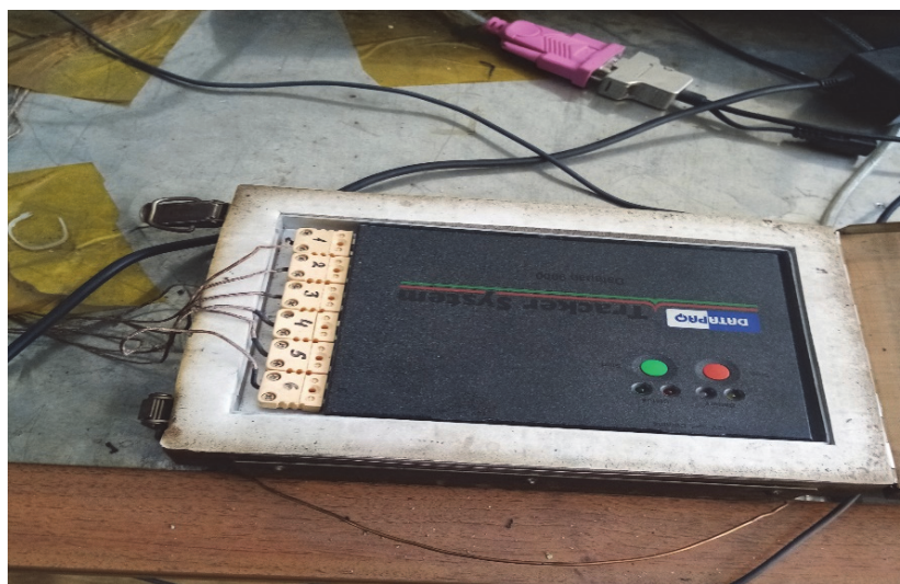
Рис. 2. Регистратор температуры ДАТАРАQ-9061 А в сушильной печи Fig. 2. DATARAQ-9061 A temperature recorder in a drying oven
