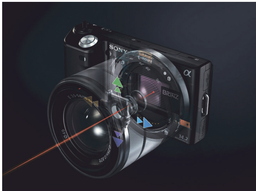
Рис. 1. Схема работы оптического стабилизатора в объективе Fig. 1. Operation diagram of the optical stabilizer in the lens
