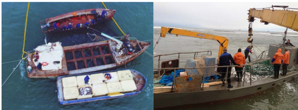
Рис. 2. Загрузка транспортных ботов у невода (снимок с дрона) и разгрузка береговым краном (Авторское фото доктора технических наук, профессора Дальневосточного федерального университета А.П. Аносова)
