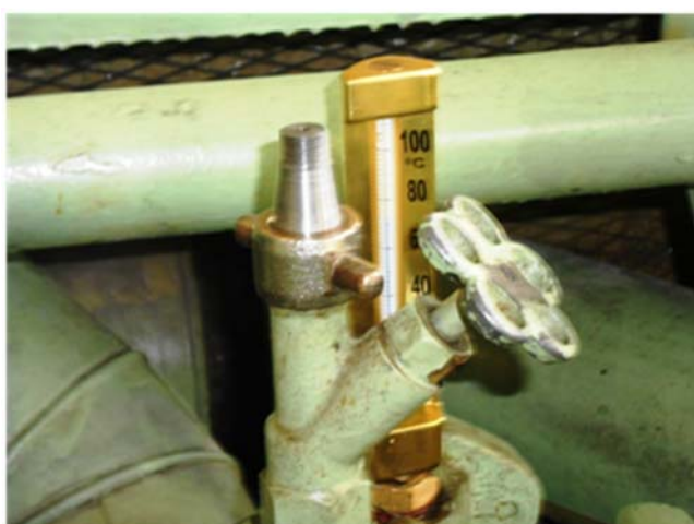
Рис. 3. Общий вид устройства для отбора частиц сажи из камеры сгорания судового дизеля 6ЧН 24/36
