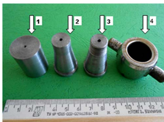
Рис. 4. Детали устройства для отбора проб частиц сажи из камеры сгорания судового дизеля 6ЧН 24/36: 1 – цилиндрическая насадка с отверстием диаметром 1мм; 2 и 3 – сопла (основное и запасное) с входным диаметром 8 мм и выходным диаметром 1,7мм; 4 – накидная гайка для крепления устройства на индикаторный канал дизеля
