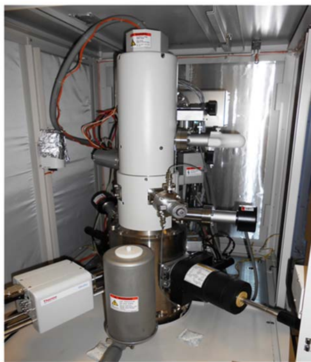
Рис. 6. Общий вид электронной пушки сканирующего микроскопа S 5500 Fig. 6. Common look electronic of cannon scan of microscope S 5500
