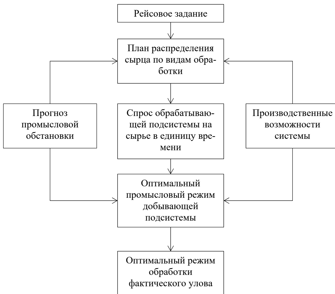
Рис. 1. Схема оптимального промыслово-технологического режима обработки улова на добывающем судне с законченным производственным циклом [2] Fig. 1. Scheme of optimal fishing and technological mode of catch processing on a mining vessel with a completed production cycle [2]
