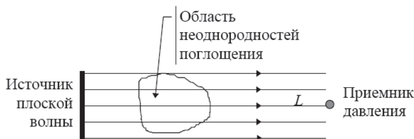
Рис. 5. Прохождение плоских волн через область неоднородностей Fig. 5. Passage of plane waves through the region of inhomogeneities
