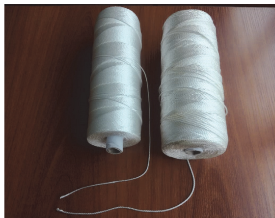
Рис. 2. Нитки полиамидные 187 текс x 6 и 187 текс x 9 Fig. 2. Polyamide threads 187 текс x 6 и 187 текс x 9
