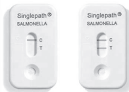
Рис. 5. Иммунографический тест Singlepath® для экспрессного определения сальмонелл (слева – отрицательный ответ, справа – положительный ответ)
