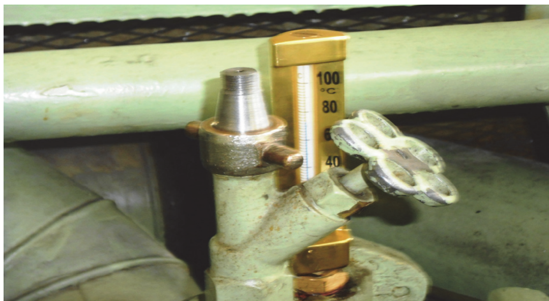
Рис. 2. Общий вид устройства для отбора частиц сажи из камеры сгорания судового дизеля 6ЧН 24/36 Fig. 2. General complexion of device for selection particles of soot from marine diesel combustion chamber 6 ChN 24/36
