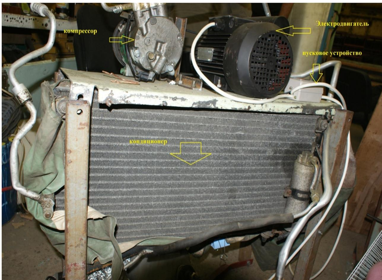
Рис. 4. Вид со стороны конденсатора
