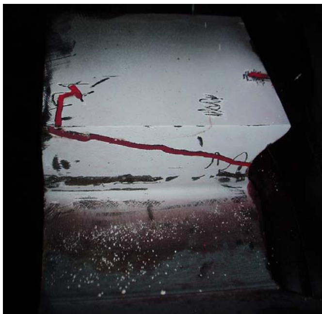
Рис. 2. Расположение трещины на носовой щеке 1-го колена (границы трещины выделены маркером) Fig. 2. The location of crack on the 1 st crankshaft web
