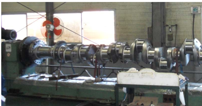
Рис. 3. Станок для протачивания шеек коленчатого вала Fig. 3. Machine-tool for gnawing through crankpins
