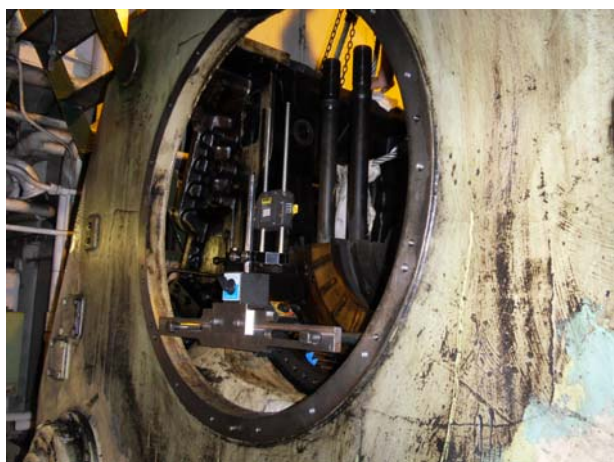
Рис. 6. Центрирование постелей подшипников коленчатого вала лазерным прибором Fig. 6. Centering of crankshaft bearing beds by a laser device
