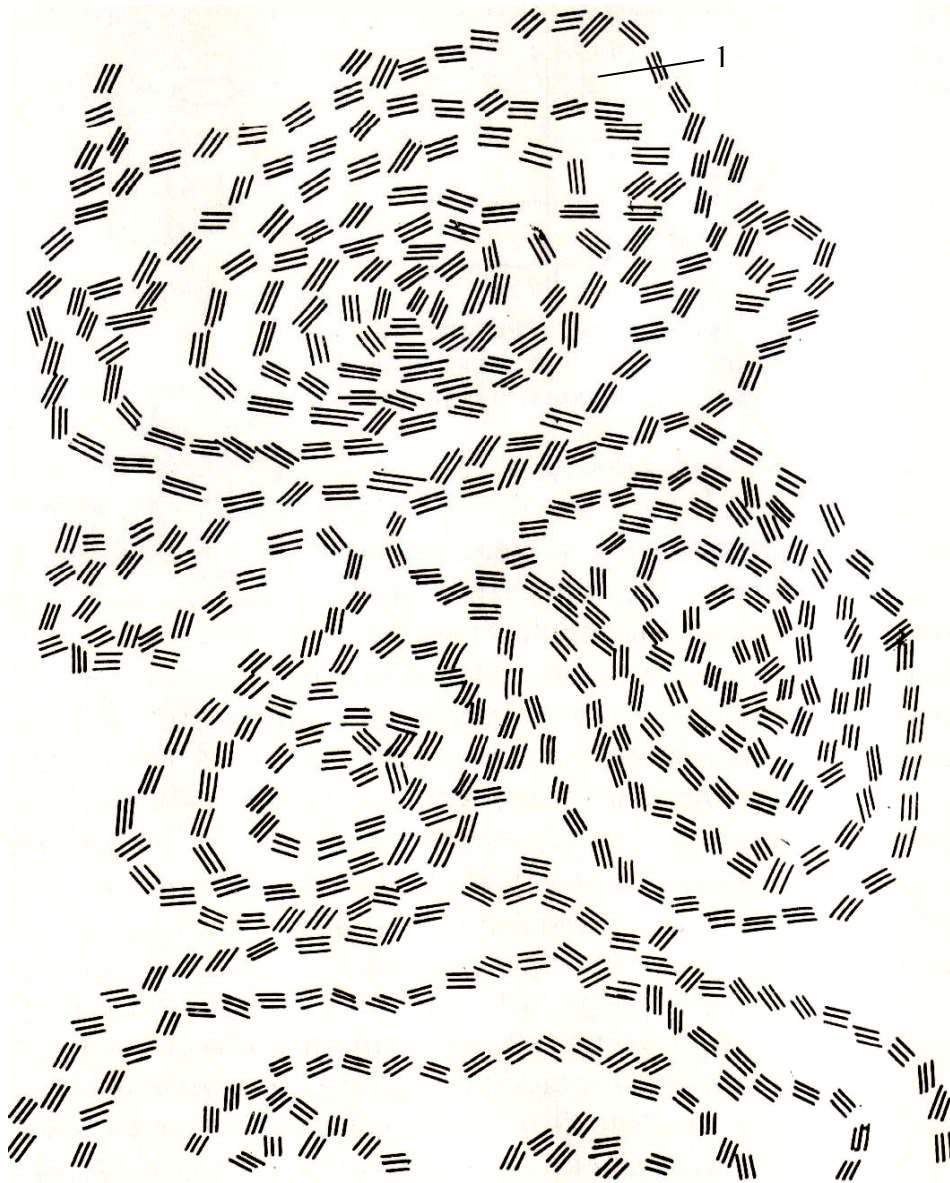
Рис. 3. Схема расположения кристаллитов в частице сажи сложной формы (реконструирование по электронной микрофотографии частицы сажи) [10]:
