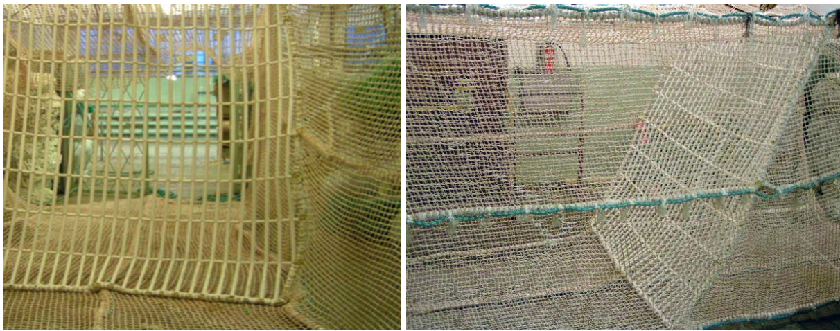
Рис. 1. Сортирующая решетка для отсортировки рыбы от креветок Fig. 1. Sorting grid for sorting fish from shrimp
