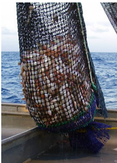
Рис. 5. Мешок, выполненный из квадратной ячеи для промысла банановой креветки
