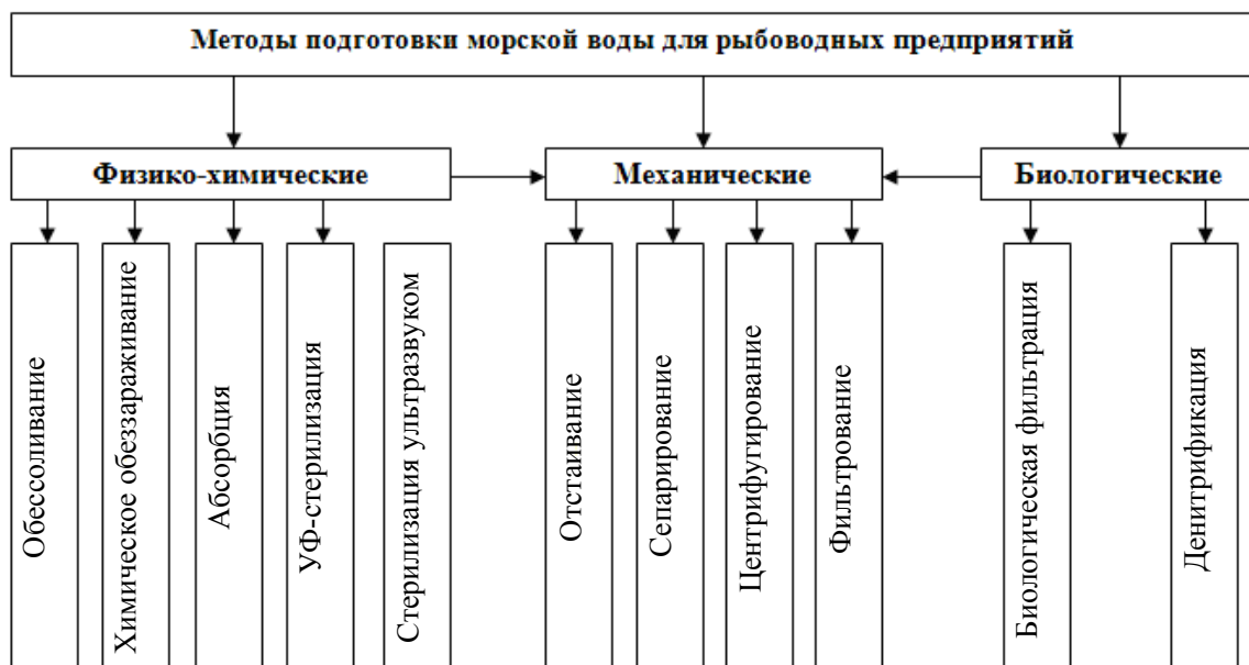
Методы подготовки морской воды для рыбоводных предприятий Methods of preparation of sea water for the fish-breeding enterprises
