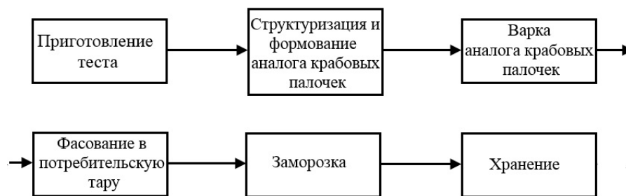
Рис. 3. Схема производства крабовых палочек с насадочным устройством
