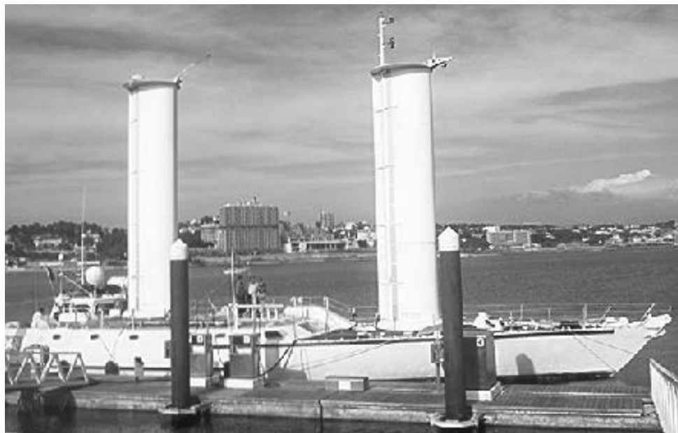
Рис. 3. Французское научно-исследовательское судно «Алсион» ( L = 27,4 м; B = 9 м; D = 76 т; N = 230 кВт), построенное по заказу Ж. Кусто для замены знаменитого «Калипсо», было оборудовано двумя турбопарусами, использующими для создания тяги отсос пограничного слоя
