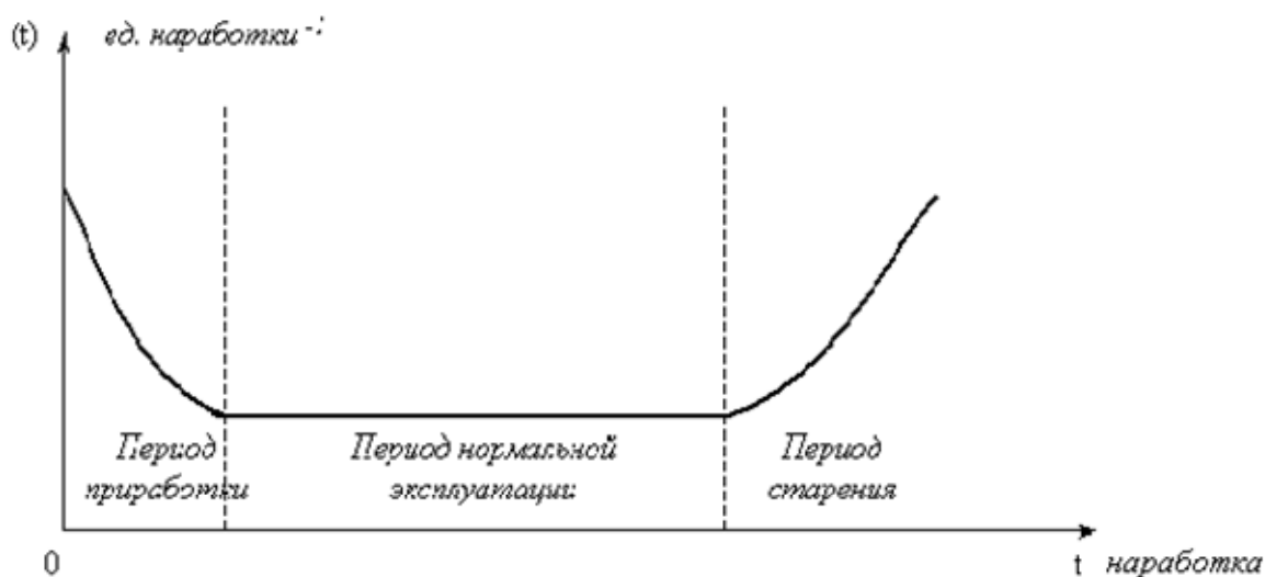
Рис. 1. Интенсивность отказов в течение срока службы изделия Fig. 1. The failure rate during the life of the product
