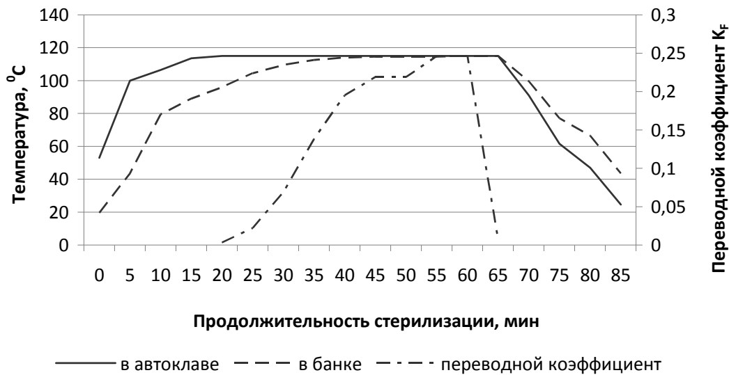
Рис. 2. Изменение температуры и греющей среды в процессе стерилизации консервов «Суп из лососевых рыб с морской капустой, овощами и перловой крупой» Fig. 2. Changing the temperature and the heating medium during sterilization «Soup with salmon fish, seaweed, vegetables and pearl barley»
