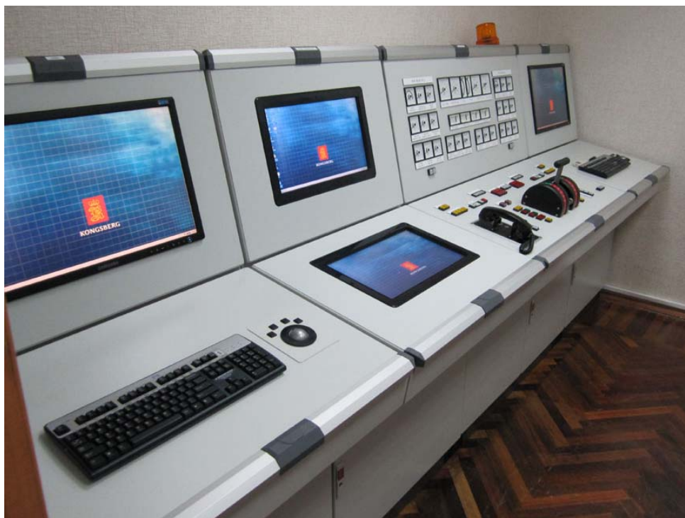
Рис. 2. Пульт управления современного тренажера машинного отделения фирмы Kongsberg Maritime
