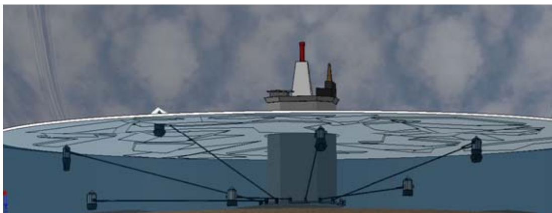
Рис. 11. Модель устройства активной защиты от ледовых нагрузок, использующей мягкие пневматические надувные емкости, выполненная в программе Solid Work Fig. 11. Device model of active protection against ice loads, use a soft, inflatable pneumatic tank made in the program Solid Work
