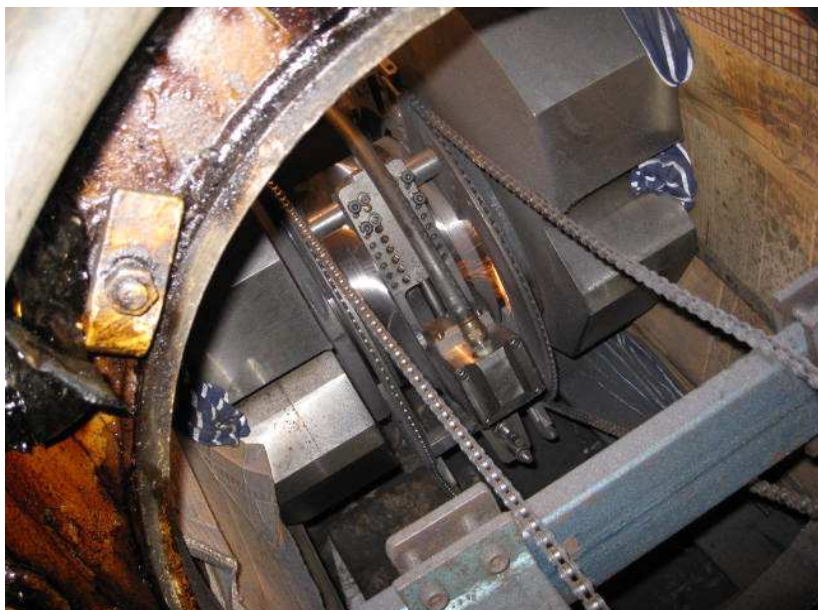
Рис. 2. Станок для протачивания шатунной шейки Fig. 2. A crank pin grinding machine
