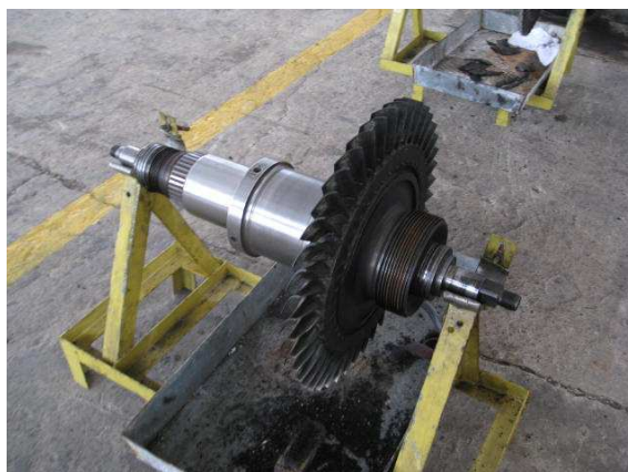
Рис. 17. Статическая балансировка турбины Fig. 17. Static balancing of the turbine
