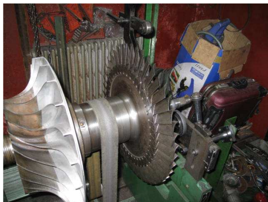
Рис. 18. Динамическая балансировка деталей вращения газотурбонагнетателя Fig. 18. Dynamic balancing of turbocharger rotating parts
