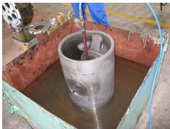
Рис. 16. Испытание герметичности поршня Fig. 16. Piston tightness test
