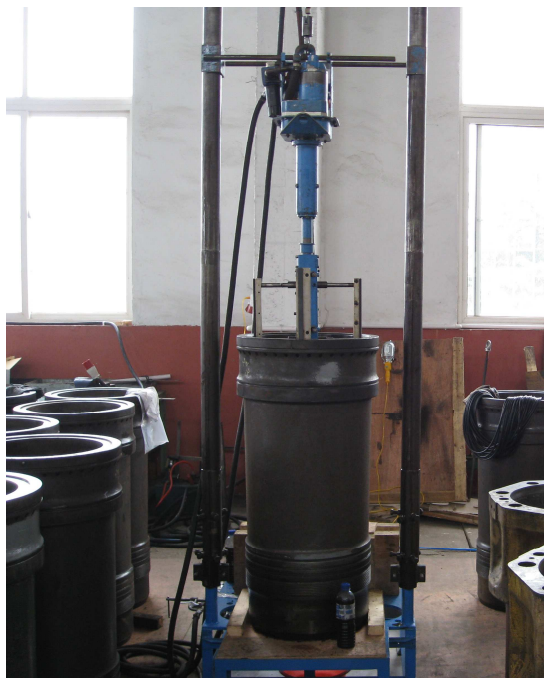
Рис. 11. Устройство хонингования цилиндрической втулки Fig. 11. The cylinder bore honing machine
