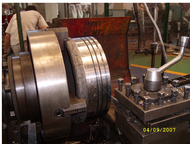
Рис. 14. Протачивание головки поршня Fig. 14. Turning down of a piston crown
