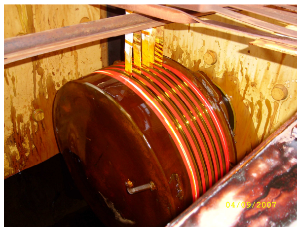
Рис. 15. Гальваническая обработка головки поршня Fig. 15. Piston crown electroplating
