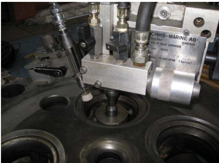
Рис. 6. Машинка для протачивания седел клапанов Fig. 6. Valve Seat Grinder
