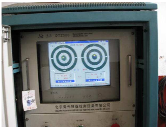
Рис. 18. Динамическая балансировка деталей вращения газотурбонагнетателя Fig. 18. Dynamic balancing of turbocharger rotating parts
