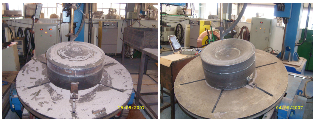
Рис. 13. Наплавка головки поршня Fig. 13. Piston crown building-up
