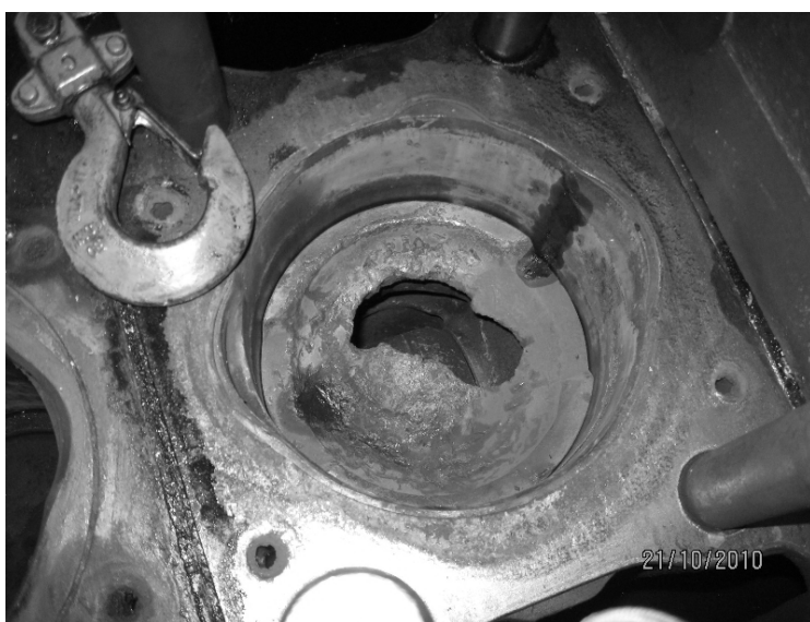
Рис. 4. Повреждение поршня цилиндра № 5 дизеля 6ЧН 18/22-225 Fig. 4. Damage of piston of cylinder № 5 of 6CH18/22-225 diesel
